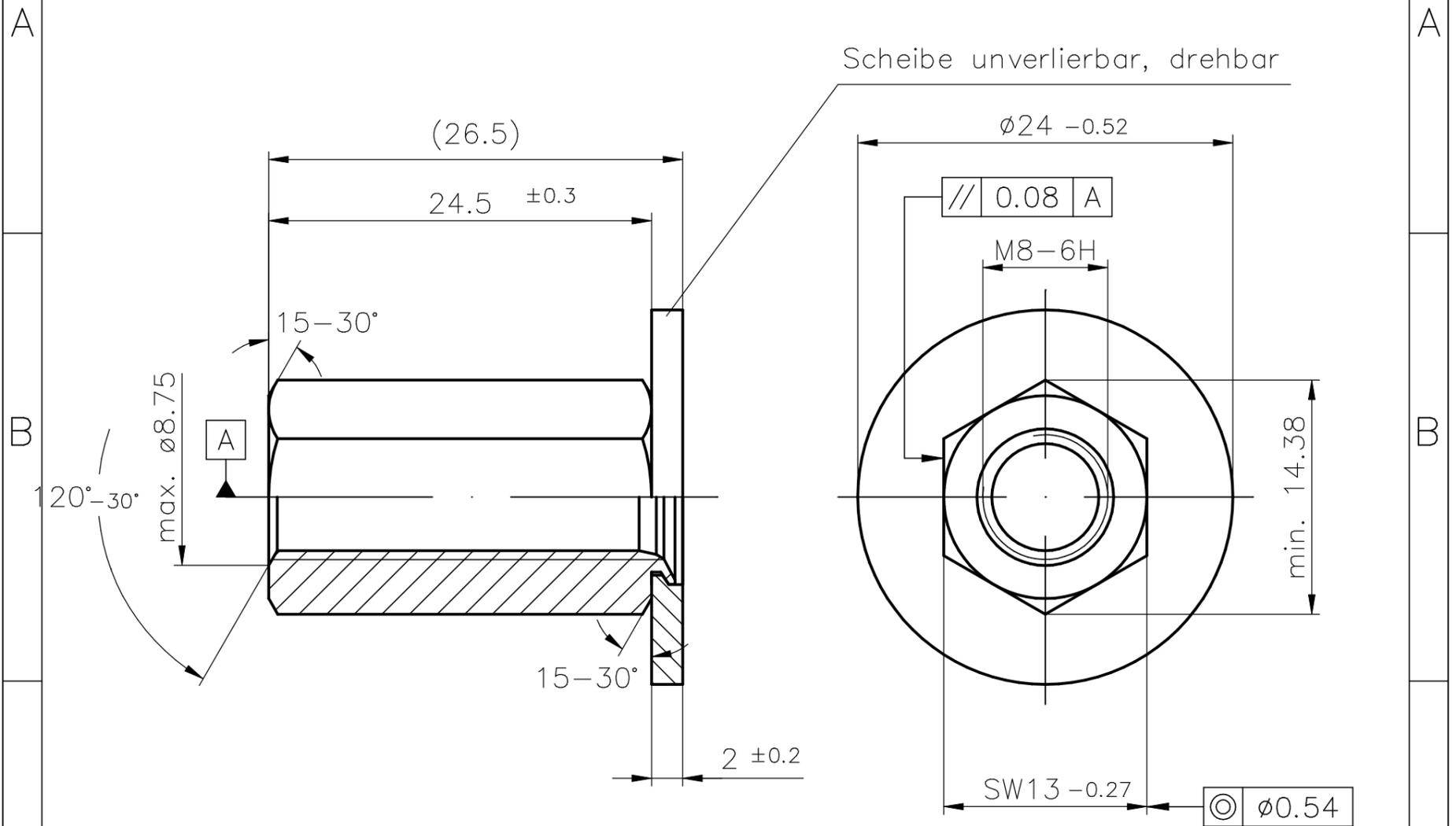
Mutter: Werkstoff 16MnCr5 ww. C35Pb, min. 200 HV
