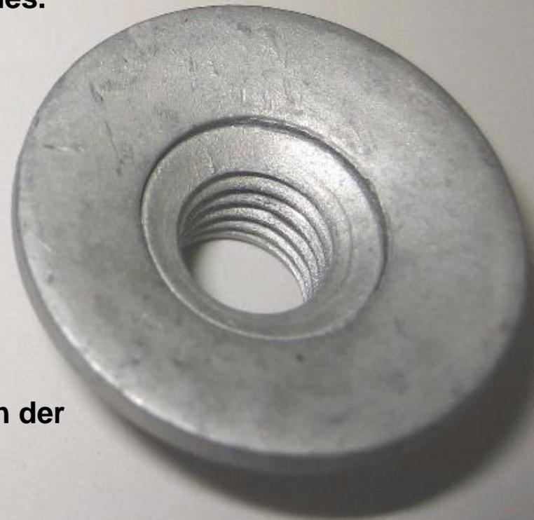
Je nach Geometrie werden in einzelnen Bereichen der Oberfläche ein und desselben Gewindeteiles sehr unterschiedliche Schichtdicken erzielt.
