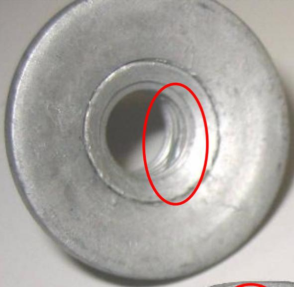
Während auf den Außenbereichen der Gesamtoberfläche eine annähernd gleichmäßige, maßhaltige Schichtdicke erreicht wird, verrunden Tauchbeschichtungen einerseits, aufgrund Ihrer Oberflächenspannung, den Gewindegrund, andererseits erfolgen Auffüllungen durch die Schöpfwirkung des Innengewindes.
